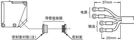
注：装配导管连接器时，注意密封套衬垫的方向。此外，为了保持防水性，把密封套衬垫底座表面和端子罩的衬垫支架平整接合。
